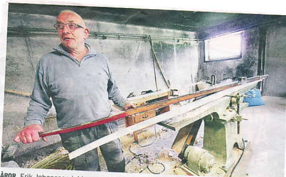
ÅROR. Erik Johansson jobbar med att såga och slipa till årskäften. En gammal åra från Hallstahammar får fungera som mall.
